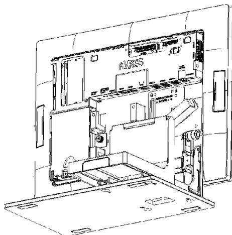
3. Détacher le pied en dévissant les 10 vis de fixation
