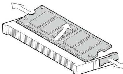
4. Faites glisser le nouveau module mémoire dans le logement et poussez vers le bas jusqu'à ce que les languettes d'éjection se verrouillent.
